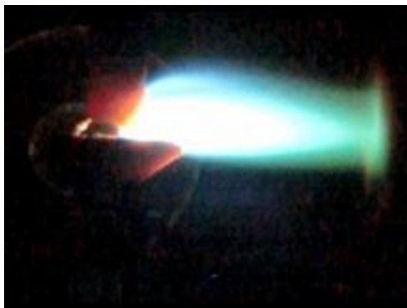
図 7 鉄推進剤の時のアークジェットの写真。 I_d = 500 \text{ A} 、準定常放電、 B_y = 4 \text{ mT} 。
