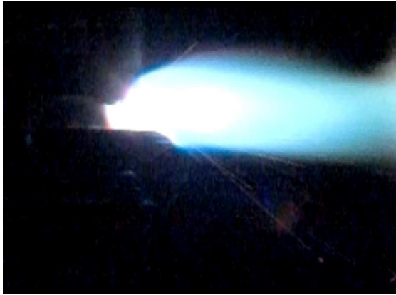
図 8 一度放電が途切れた後に、 I_d=500A の放電がパルス的に開始した時のアークジェット写真。鉄推進剤、 p(\text{Ar})=5\text{kPa} 、 B_y=4\text{mT} 。
