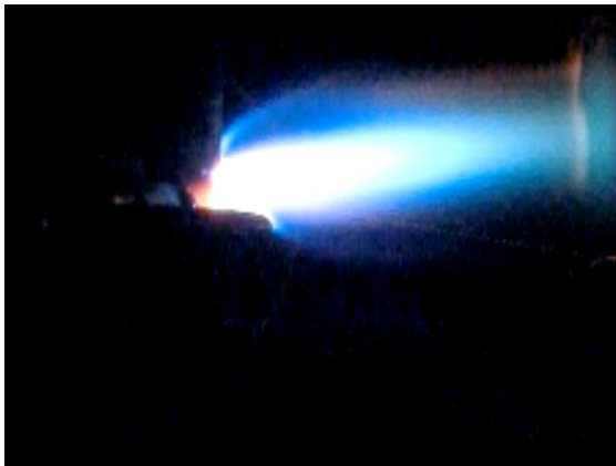
図 9 I_d=100-500A でパルス変調させた時のアークジェット写真。図 8 との比較。鉄推進剤、 p(\text{Ar})=5\text{kPa} 、 B_y=4\text{mT} 。
