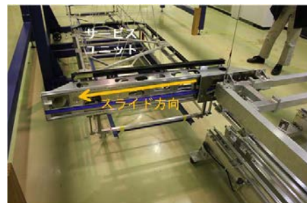
図4 展開トラス構造物組立技術地上実証実験（左は展開結合試験、右は展開装置移動試験）
