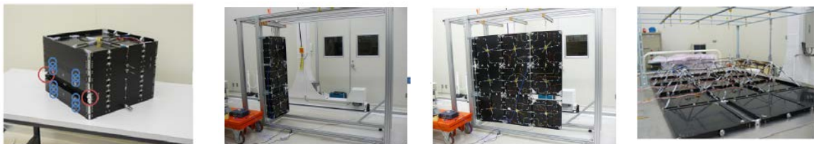
1. 収納時 2. 1次展開後 2. 2次展開後 3. バックストラクチャー展開後
