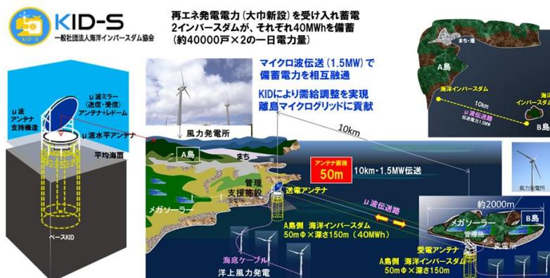
図4: 海洋インバースダムを用いた島嶼間マイクロ波送電システムの概要
